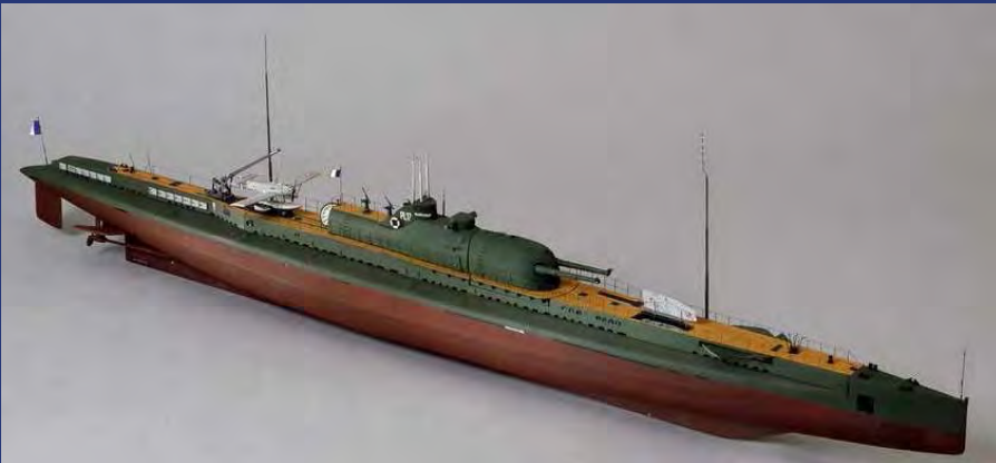
Le Surcouf : 120 m de long x 9 m, 3 000 t, 18 nœuds en surface, 10 en plongée. 2 canons de 203 mm, 2 de 37 mm, 4 mitrailleuses, 2 Lewis Guns, 6 tubes lance-torpilles, petit hydravion – Effectifs : 125.
